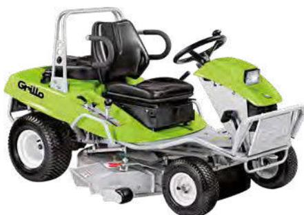
EMBAYAGE ELECTROMAGNETIQUE ET BLOCAGE DIFFERENTIEL, ROUES GAZON, ARCEAU DE SECURITE ET CROCHET D'ATTELAGE - SIEGE AMORTI
